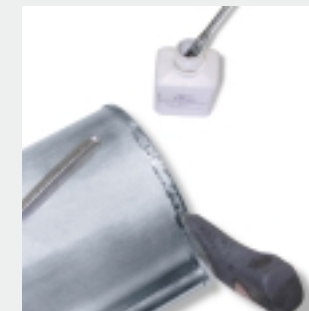
... podczas procesu lutowania uzyskać możliwie jak najmniejszą szczelinę
